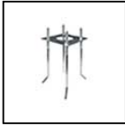
S.2849 PERNOS para POSTE S.2801, S.2813, S.2843, S.2845 en acero zincado C= 200mm, D=200mm E=Ø80mm, h=460mm, h1=90mm. M16. Para fijar los pernos se aconseja el uso de una plantilla de cemento armado de dimensiones**: A = 0.7 m B = 0.7 m **Las dimensiones de la plantilla deben ir en función de la consistencia del terreno, siguiendo las normativas UNI EN 40. RECOMENDAMOS EL USO DE LOS SIGUIENTES ACCESORIOS : S.2801, S.2813, S.2843, S.2845 POSTE
