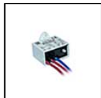
S.2499 SCARICATORE SOVRATENSIONE 10kV CLASSE II Compatibile con tutti gli apparecchi di illuminazione ed alimentatori elettronici in Classe di Isolamento CLASSE II Tensione di funzionamento 230-277V SPD type 2+3 Tensione massima di scarica 10kV grado di protezione IP67 DEVE ESSERE PREVISTO N°1 SCARICATORE DI SOVRATENSIONE PER OGNI APPARECCHIO DI ILLUMINAZIONE E DEVE ESSERE INSTALLATO A MAX 10m DI DISTANZA DA QUEST'ULTIMO.
