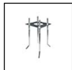
S.2849 TIRAFONDI per pali S.2801, S.2813, S.2843, S.2845 in acciaio zincato con bulloni M16, C= 200mm, D=200mm E=Ø80mm, h=460mm, h1=90mm. Si consiglia l'uso in plinto di cemento armato di dimensioni **: A = 0.7 m B = 0.7 m ** Le dimensioni del plinto possono essere ottimizzate a seconda della consistenza del terreno, seguendo le indicazioni delle normative UNI EN 40.
