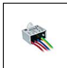
S.2498 SCARICATORE SOVRATENSIONE 10kV CLASSE I Compatibile con tutti gli apparecchi di illuminazione in Classe di Isolamento CLASSE I Tensione di funzionamento 230-277V SPD type 2+3 Tensione massima di scarica 10kV grado di protezione IP67 DEVE ESSERE PREVISTO N°1 SCARICATORE DI SOVRATENSIONE PER OGNI APPARECCHIO DI ILLUMINAZIONE E DEVE ESSERE INSTALLATO A MAX 10m DI DISTANZA DA QUEST'ULTIMO.
