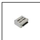
S.3413 ALIMENTATORE IP55 RGBW 90W 230V/24V PWM DMX MAX 5 USCITE Box di alimentazione IP55 con trasformatore 90W 230V/24V PWM controllabile con sistema DMX. Il numero massimo degli apparecchi collegabili dipende dalla somma delle singole potenze. Dimensioni 260mmx260mmx100mm SI CONSIGLIA L'UTILIZZO DELLO SCARICATORE DI SOVRATENSIONE S.2499 PER OGNI ALIMENTATORE ELETTRONICO CHE DEVE ESSERE INSTALLATO A MAX 10m DI DISTANZA DA QUEST'ULTIMO.
