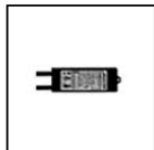
S.2448 ALIMENTATORE ON-OFF 0-31W 230Vac/48Vdc IP67 Alimentatore per led monocolor 0-31W 230Vac/48Vdc Il numero massimo degli apparecchi collegabili dipende dalla somma delle singole potenze. IP67 CLASSE II SELV Dimensioni 112x38x25mm SI CONSIGLIA L'UTILIZZO DELLO SCARICATORE DI SOVRATENSIONE S.2499 PER OGNI ALIMENTATORE ELETTRONICO CHE DEVE ESSERE INSTALLATO A MAX 10m DI DISTANZA DA QUEST'ULTIMO.
