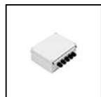
S.2402 ALIMENTATORE NON DIMMERABILE IN BOX PER LED 60W 230Vac/24Vdc IP55 MAX 5 USCITE BOX IP55 60W 24Vdc Dimensioni: 260 x 240 x 100 mm. In entrata: N°2 pressacavi PG11 In uscita: N°5 pressacavi PG11 IP55 CLASSE II SELV SI CONSIGLIA L'UTILIZZO DELLO SCARICATORE DI SOVRATENSIONE S.2499 PER OGNI ALIMENTATORE ELETTRONICO CHE DEVE ESSERE INSTALLATO A MAX 10m DI DISTANZA DA QUEST'ULTIMO.
