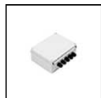
S.2404 ALIMENTATORE NON DIMMERABILE IN BOX PER LED 90W 230Vac/24Vdc IP55 MAX 5 USCITE BOX IP55 90W 24Vdc Dimensioni: 260 x 240 x 100 mm. In entrata: N°2 pressacavi PG11 In uscita: N°5 pressacavi PG11 IP55 CLASSE II SELV SI CONSIGLIA L'UTILIZZO DELLO SCARICATORE DI SOVRATENSIONE S.2499 PER OGNI ALIMENTATORE ELETTRONICO CHE DEVE ESSERE INSTALLATO A MAX 10m DI DISTANZA DA QUEST'ULTIMO.
