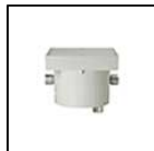
S.3660 POZZETTO IP65* Pozzetto di derivazione per cablaggio fornito di pressacavi per 3 ingressi (ulteriori 3 ingressi apribili con accessorio S.3670). Carico massimo 500Kg Dimensioni 300mmx300mmx230mm
