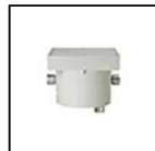
S.3660 POZZETTO IP65* Pozzetto di derivazione per cablaggio fornito di pressacavi per 3 ingressi (ulteriori 3 ingressi apribili con accessorio S.3670). Carico massimo 500Kg Dimensioni 300mmx300mmx230mm
