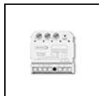
S.2490 Convertitore segnale Input PUSH DIM Output DALI 2 Caratteristiche regolazione DALI-2 (1-100%). Unità di controllo per la conversione da un pulsante ad un'interfaccia DALI-2. Consente un controllo fino ad un massimo di 35 punti di interfaccia DALI-2 in BROADCAST. Corrente di comando typ. 70 Ma - max. 110 Ma. Applicazione nella cassetta di derivazione. Regolazione della luminosità mediante la funzione PUSH: - una pressione breve per accendere e spegnere; - una pressione prolungata per aumentare o diminuire l'intensità luminosa. Dimensioni 43mm x 46mm x 18,5mm Compatibile con il protocollo DT6 e solo per LED monocromatici
