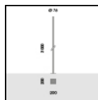
S.2813 PALO CILINDRICO H 3,0m f.t., Ø76mm FLANGIATO
