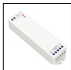
S.3460 INDIRIZZATORE DMX512 / RDM Permette l'indirizzamento automatico dei prodotti RGBW con il DMX integrato tramite il protocollo RDM. Una volta terminata la procedura di assegnazione degli indirizzi, questo accessorio può essere rimosso dall'impianto. IP20 Dimensioni 125mmx33mmx20mm
