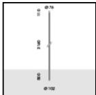
**S.2810****PALO CILINDRICO H 3,16m f.t., Ø102mm DA INTERRARE con CODOLO D'ATTACCO Ø76mm**
